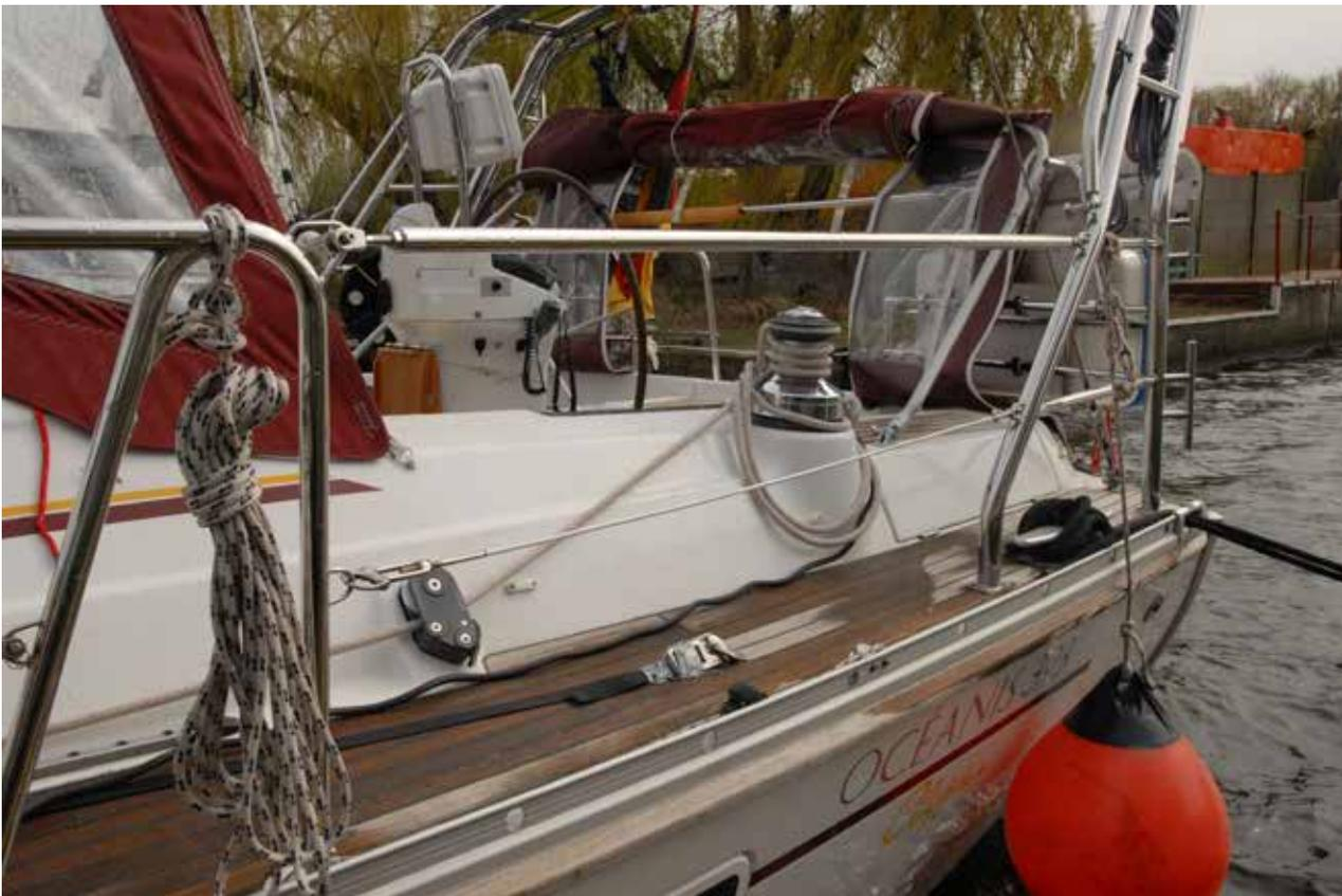
**Sicherer Verschluss und guter Halt von Durchgangsstange in Kombination mit dem Relingsdraht und Kugelsperbolzen.**
