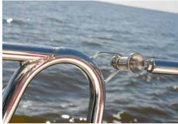
Der Kugelsperbolzen verbindet sicher die Durchgangsstang mit dem Relingsbügel.
