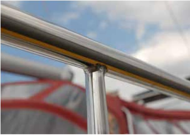
Das Edelstahlrohr wurde auf die alte Relingsstütze aufgesetzt und verschweißt.
