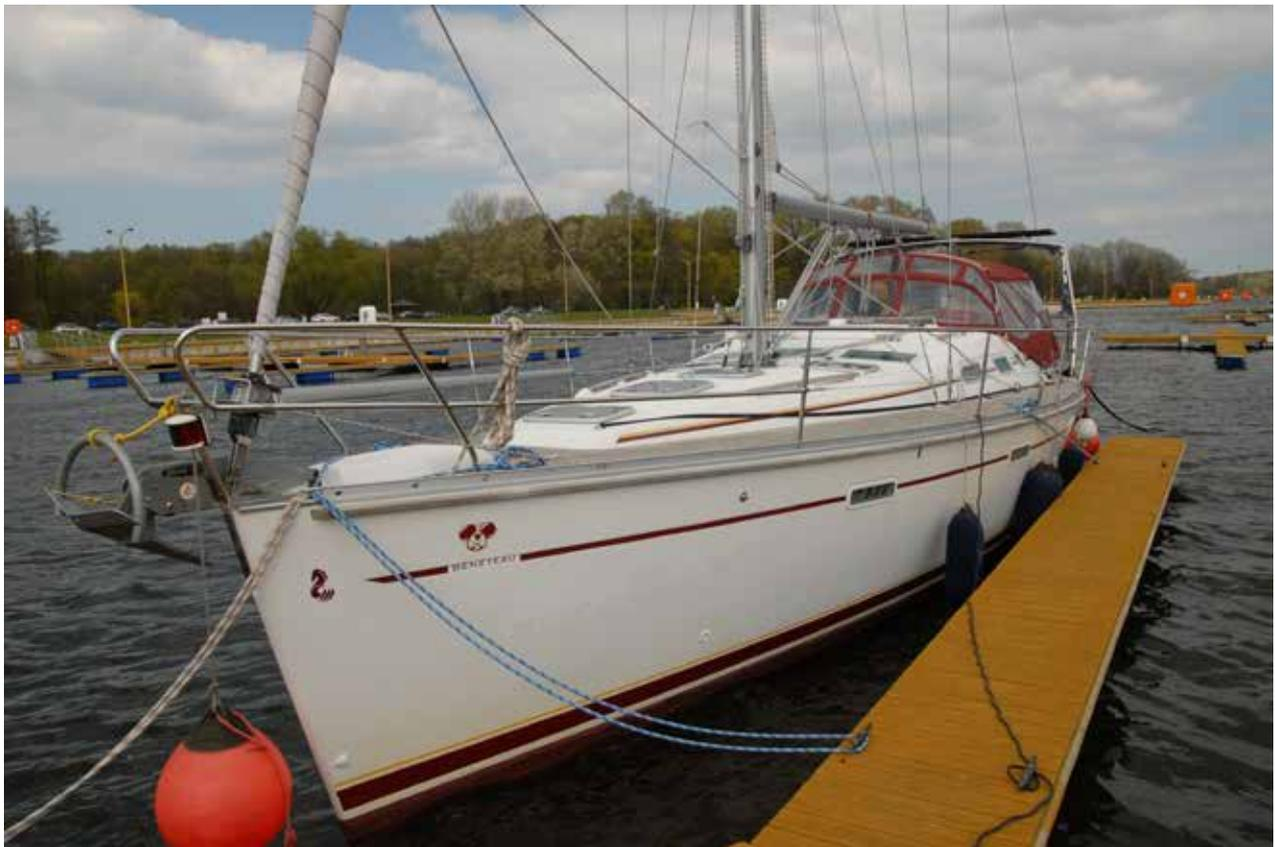
**Die neue Edelstahlrohrrailing ist fertig montiert.**
