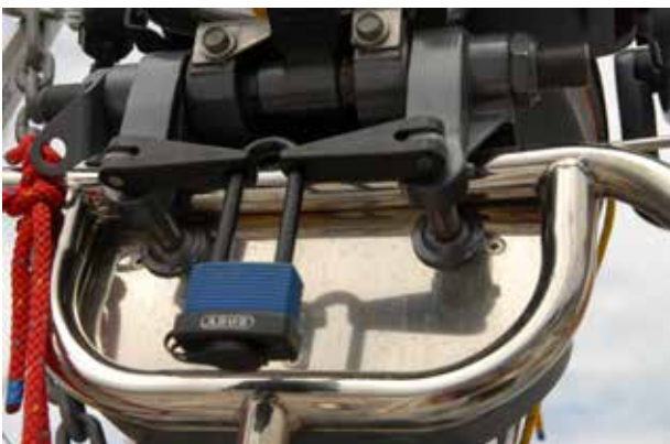
Sichere am Heckkorb verschweisste Halterung für den Außenborder.
