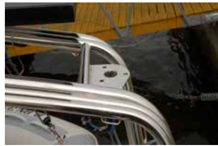
Eine Grundplatte für den Windgenerator oder die TV-SAT Antenne wurde am Heckträger angeschweisst.
