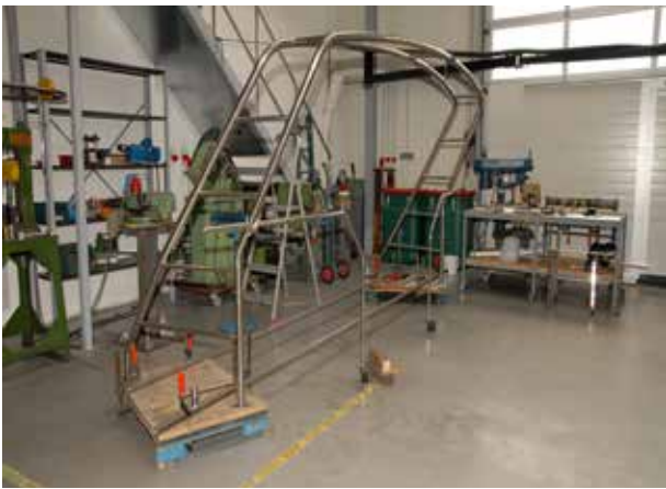
Der noch nackte Geräteträger während der Fertigung im Fachbetrieb.
