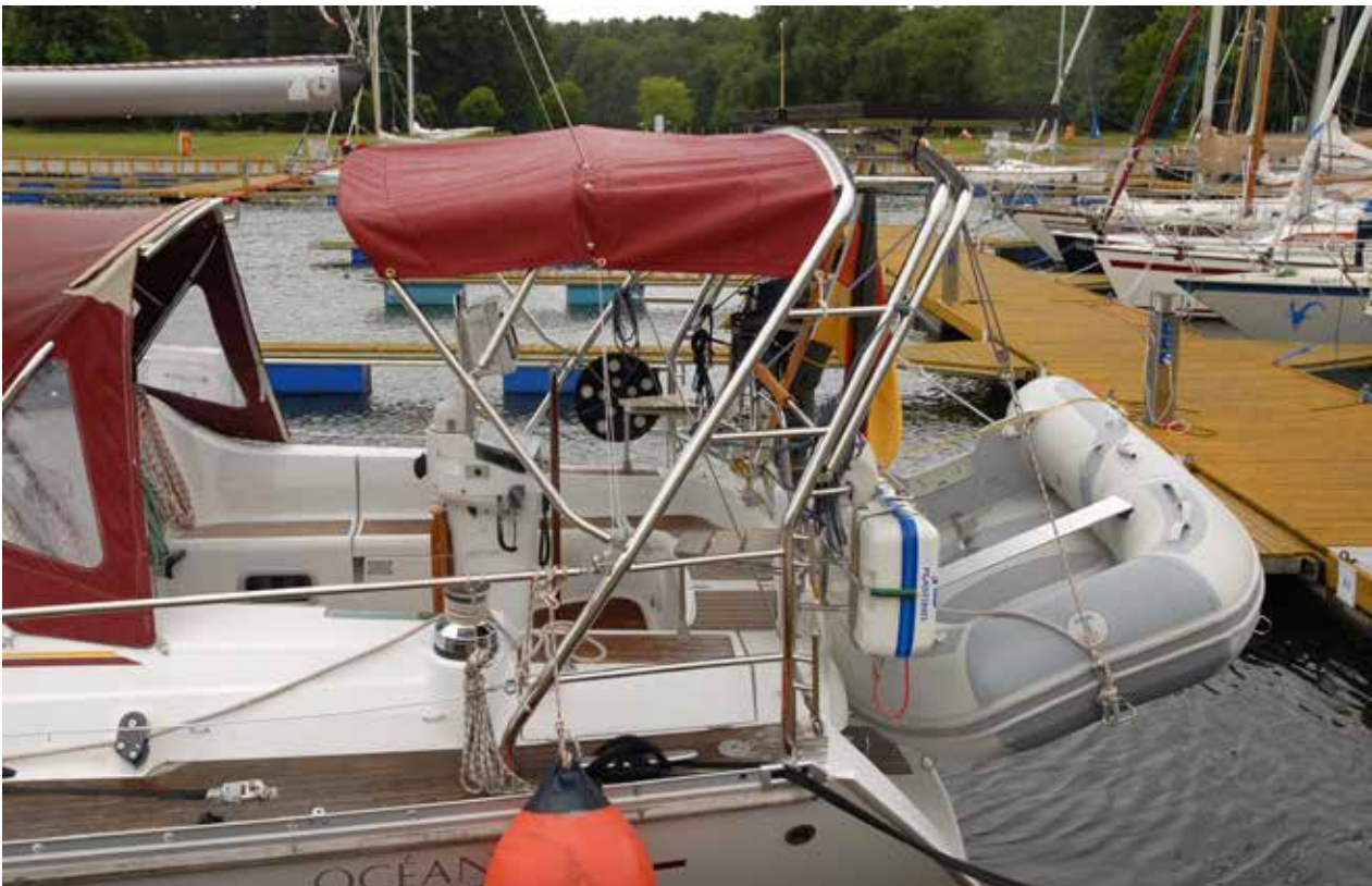
Das Dreiviertel-Bimini bietet Schutz vor Sonne und Regen für den Rudergänger.
