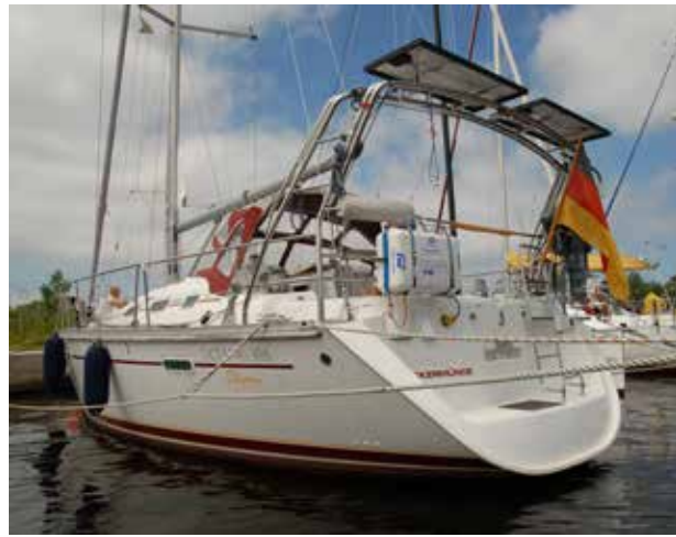
Der fertig montierte Geräteträger in der Backbord-Ansicht mit Solarpanelen.
